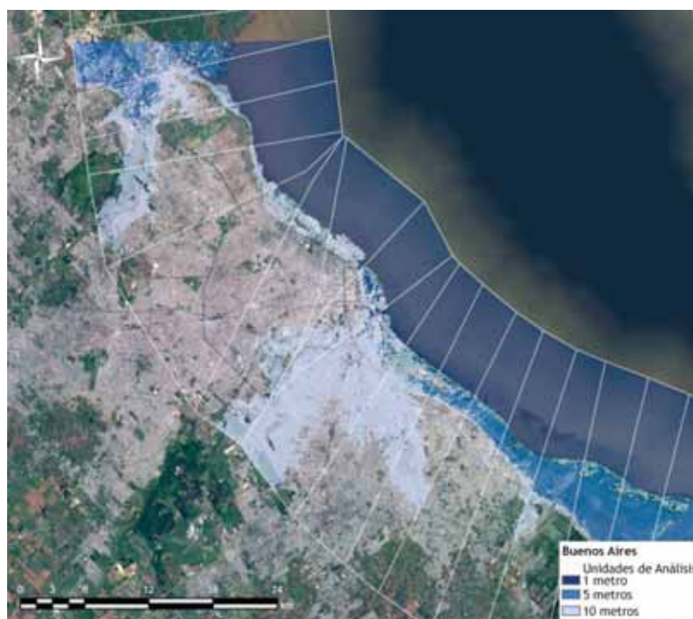
FIGURA 2.63 UNIDADES DE ANÁLISIS Y MÁSCARAS DE NIVELES DE 1, 5 Y 10 M EN BUENOS AIRES
